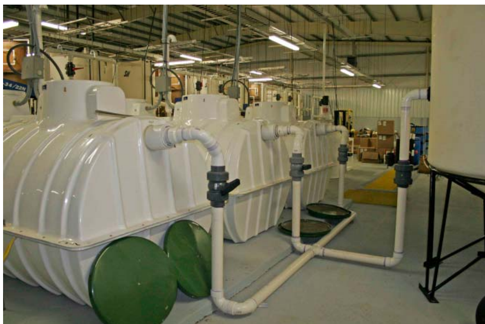
Tres reactores batch en serie (5600 L) a escala piloto que fueron usados en este estudio
