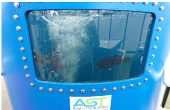
Figura 4: ASTfilters puestos en Keene High School (TX) con un estanque, un RAS PolyGeyser, y media flotante.
